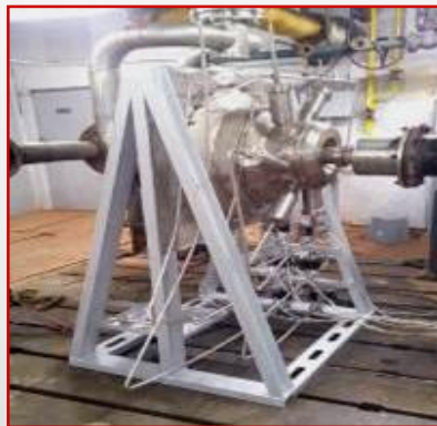
СТЕНД ИСПЫТАНИЙ КАМЕР СГОРАНИЯ
